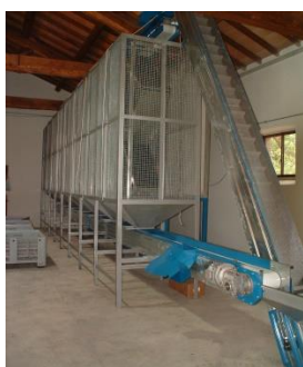
SISTEMA ASCIUGATURA CASTAGNE CON ARIA - CALIBRI PER SELEZIONE (CON MISCELATORE E BOCCHETTE MANUALI O RADIOCOMANDATE)
