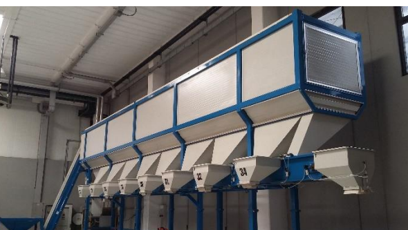
SISTEMA ASCIUGATURA CASTAGNE CON ARIA - CALIBRI PER SELEZIONE (CON MISCELATORE E BOCCHETTE MANUALI O RADIOCOMANDATE)
