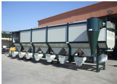
SISTEMA ASCIUGATURA CASTAGNE CON ARIA - CALIBRI PER SELEZIONE (CON MISCELATORE E BOCCHETTE MANUALI O RADIOCOMANDATE)
