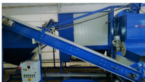
Uscita prodotto pulito per scarico ad altezza di circa 3,60 con inserimento di nastro elevatore estraibile /richiudibile per gli spostamenti
