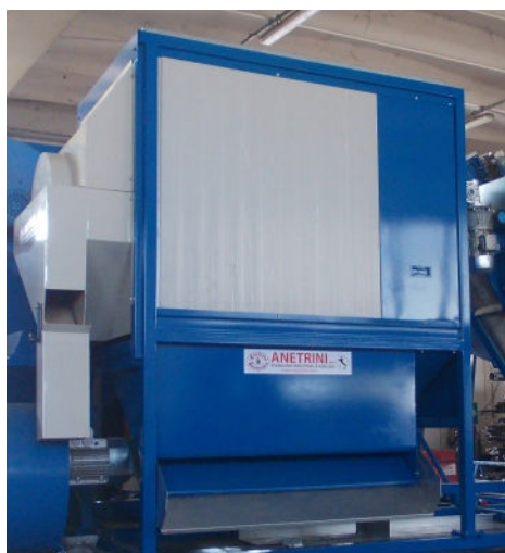
Vaglio rotante con sistema intercambiabile per pulizia vari frutti - eliminazione corpi estranei più pesanti e più grandi
