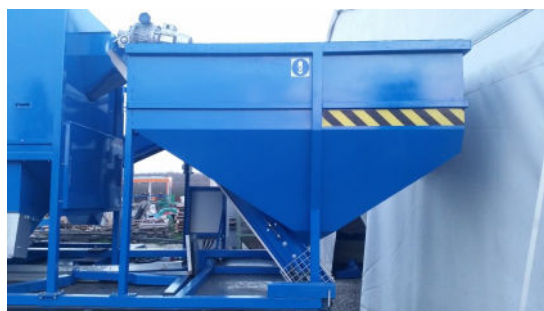
Sistema di carico con tramoggia di contenimento prodotto sporco con nastro elevatore di carico
