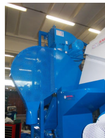
Uscita prodotto pulito ad altezza ridotta per stoccaggio in contenitori
